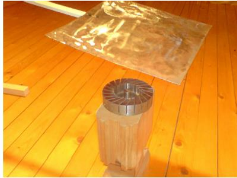
図 3. ジオパソジェニック放射が金属平面に及ぼす影響を検証するためのねじり秤：ドドノフのモジュレーターは、ねじり秤の天秤棒に取り付けられているブリキ板の下方に配置されている。
