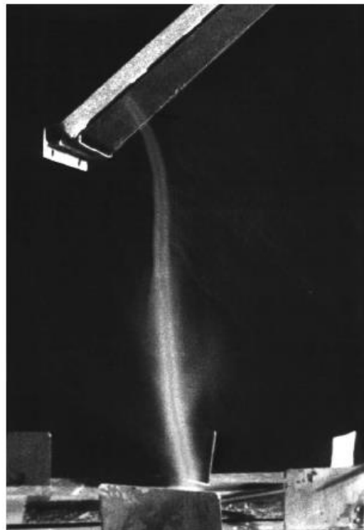
図 3.5. 飛行機（駐機中）のジェットエンジン吸気口の入口上における気体渦の圧縮
