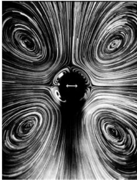
図 5.2. 振動円柱によって生成される2次渦：円柱周りの流れは、遠心ポンプとしての太陽の周りの流れと似ている。
