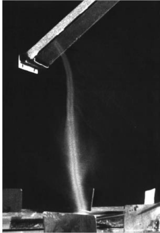
図 4.4. 飛行機（駐機中）のジェットエンジン吸気口の入口上における気体渦の圧縮
