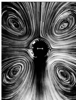
Рис. 7.11. Вторичные вихри, индицируемые колеблющимся цилиндром Течения вокруг цилиндра подобны течениям эфира вокруг Солнца как центробежного насоса
