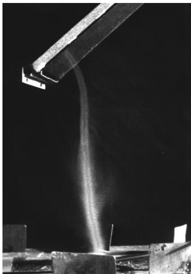
Рис. 2.5. Сжатие газового вихря на входе в воздухозаборник (слева вверху) реактивного двигателя самолета на стоянке
